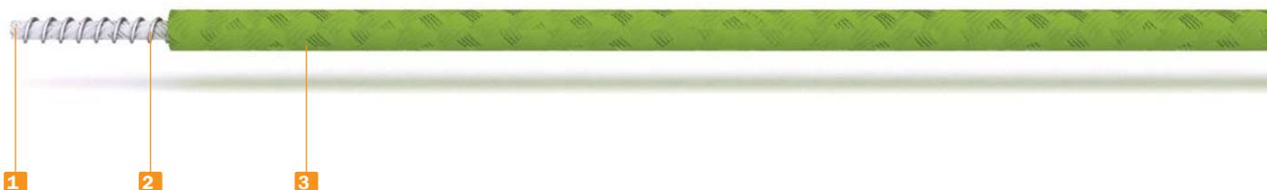
Сердечник из стеклонитей (1). Нагревательная жила из сплава высокого сопротивления(2), изоляция и оболочка из стеклонитей(3).
