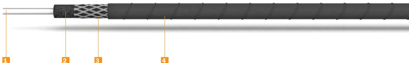
Нагревательная жила из сплава высокого сопротивления (1). Изоляция из фторопластовых пленок(2), экран из медных проволок(3) и оболочка из фторопластовых пленок(4).
