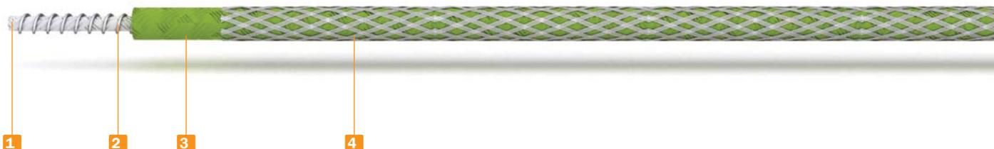
Сердечник из стеклонитей (1). Нагревательная жила из сплава высокого сопротивления(2), изоляция и оболочка из стеклонитей(3), экран из стальных нержавеющих проволок(4).
